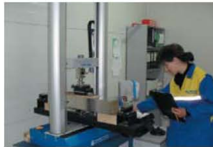
Испытание на сдвиг-срез.
