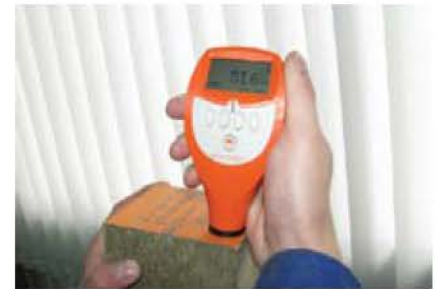
Проверка толщины покрытия.
