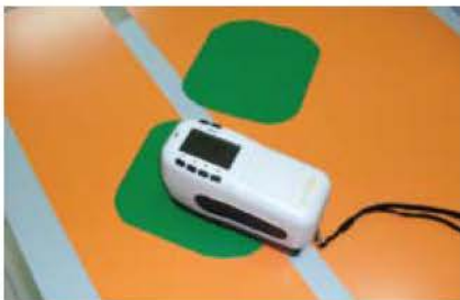
Проверка разнооттеночности покрытия.
